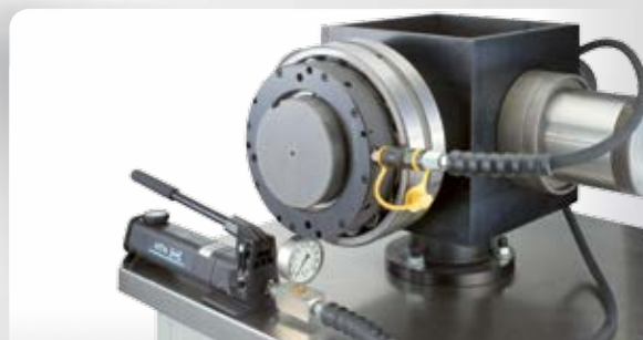
Извлечение стяжной втулки с помощью гидравлической гайки
